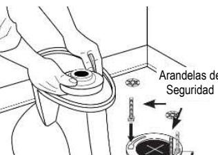
**IMPORTANTE:** No levante ni meza el inodoro después de colocar. Se debe instalar un nuevo empaque si se rompe el sellado.
